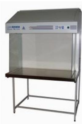
Carpenteria esterna in lamiera di acciaio (spessore 12/10), verniciatura epossidica.
